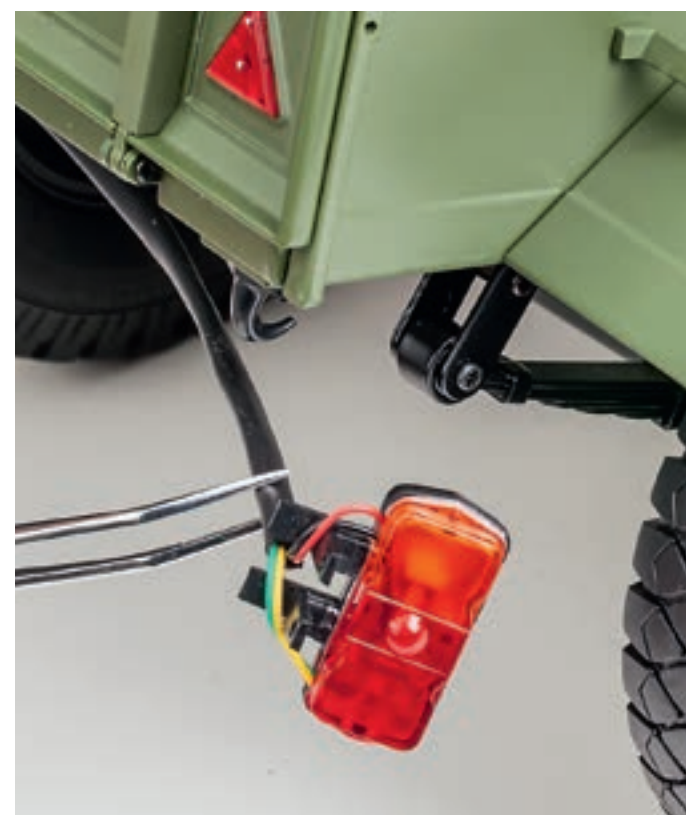
Шаг 7. Аналогичным образом разместите светодиоды в корпусе правого заднего фонаря прицепа. Поверх корпуса фонаря установите стекло.
