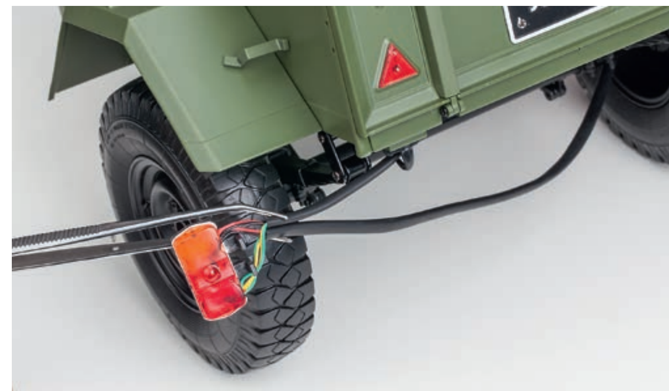
Шаг 5. Поверх корпуса левого фонаря поместите стекло заднего фонаря. Желтая секция стекла должна располагаться в верхней части корпуса (под ней не должно быть светодиода). Совместите крепежные штифты стекла с ответными отверстиями корпуса и плотно прижмите детали друг к другу.
