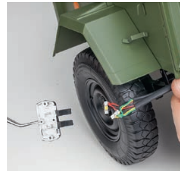
Шаг 4. Разместите светодиоды фонарей прицепа в корпусе левого фонаря (светодиоды со сдвоенными проводами). Светодиод с красными и черными проводами должен располагаться в средней части фонаря, а светодиод с зелеными и желтыми проводами — в нижней части. Уложите провода таким образом, чтобы обойти крепежные элементы корпуса фонаря.
