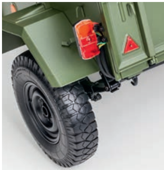
Шаг 6. Установите собранный левый фонарь в задней части левой стенки прицепа. Для фиксации детали используйте два винта 1,7×4 (СМ). Провода от фонаря должны идти вниз за его кронштейном.
