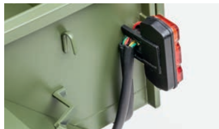
Шаг 6. Установите собранный левый фонарь в задней части левой стенки прицепа. Для фиксации детали используйте два винта 1,7×4 (СМ). Провода от фонаря должны идти вниз за его кронштейном.
