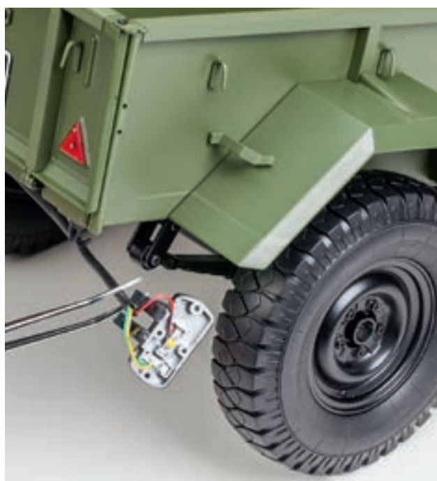
Шаг 7. Аналогичным образом разместите светодиоды в корпусе правого заднего фонаря прицепа. Поверх корпуса фонаря установите стекло.
