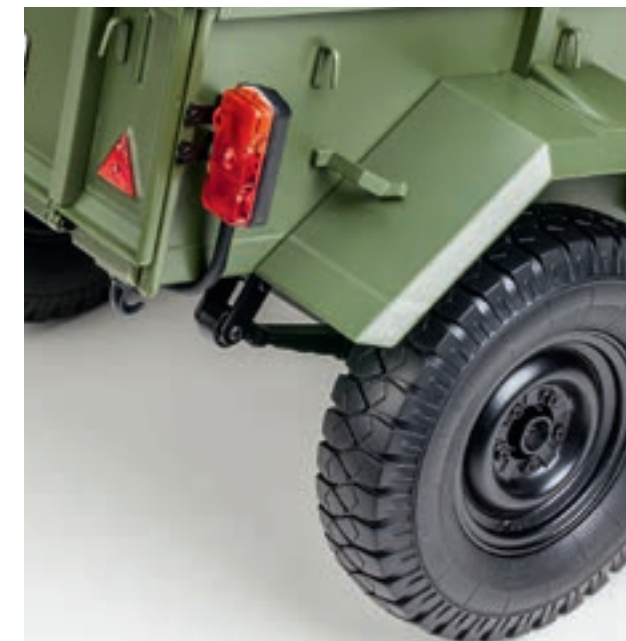
Шаг 8. При помощи двух винтов 1,7×4 (СМ) закрепите собранный фонарь на правой боковой стенке прицепа.
