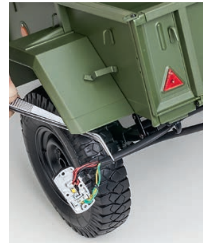
Шаг 4. Разместите светодиоды фонарей прицепа в корпусе левого фонаря (светодиоды со сдвоенными проводами). Светодиод с красными и черными проводами должен располагаться в средней части фонаря, а светодиод с зелеными и желтыми проводами — в нижней части. Уложите провода таким образом, чтобы обойти крепежные элементы корпуса фонаря.
