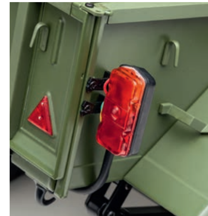
Шаг 8. При помощи двух винтов 1,7×4 (СМ) закрепите собранный фонарь на правой боковой стенке прицепа.
