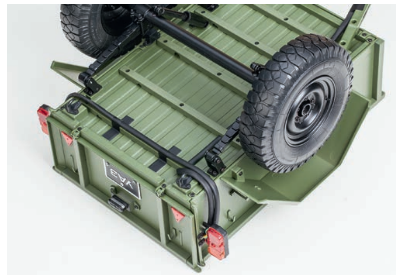
Шаг 9. Провод, идущий от левого фонаря к правому, уложите вдоль усилителя пола кузова и закрепите при помощи нескольких полос клейкой ленты.
